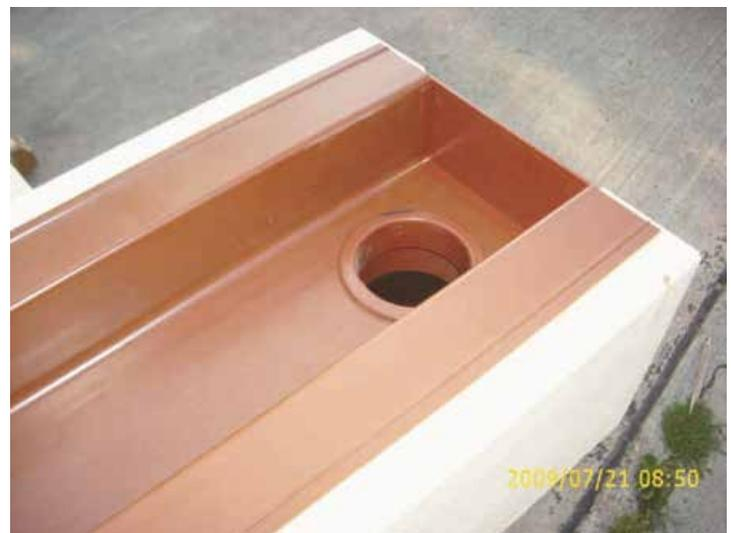
Ein Loch mit Durchmesser 68mm (bei Doppelcarports 93-95mm) für den Ablaufstutzen mit einer Lochkreissäge in die Rinne schneiden. Den Ablaufstutzen einschrauben.
